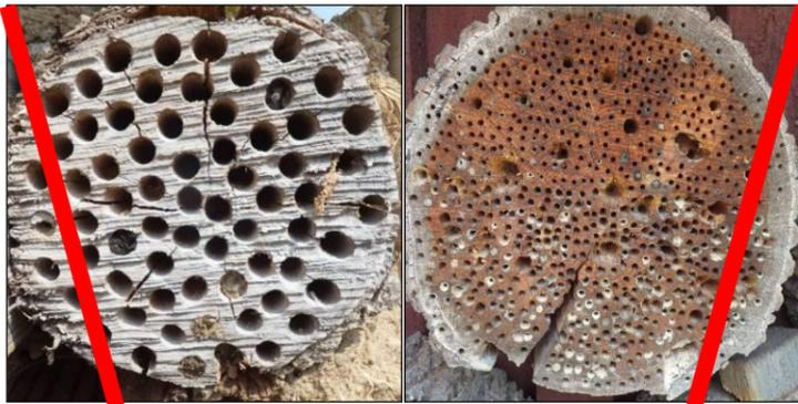
Baumscheiben mit zu geringem Abstand der Bohrungen. Dadurch erhöht sich die Gefahr der Radialrissbildung.
