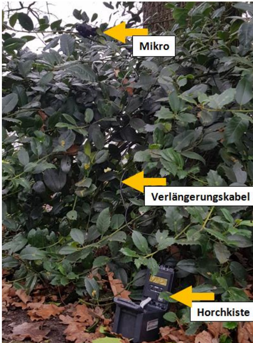
Abbildung 5. Aufbau einer Horchkiste (Batlogger A+) im Gelände
